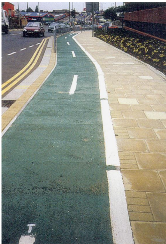
Εικόνα 9: Συνοδευτικός διάδρομος διπλής κατεύθυνσης στο ύψος του πεζοδρομίου διακριτό σε χρώμα και υφή υλικό διάστρωσης και σε απόσταση 50 cm από το οδόστρωμα.
