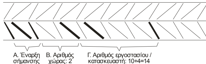
Σχήμα 2-6 Παράδειγμα σήμανσης για την αναγνώριση χάλυβα B500C που προέρχεται από κουλούρα
